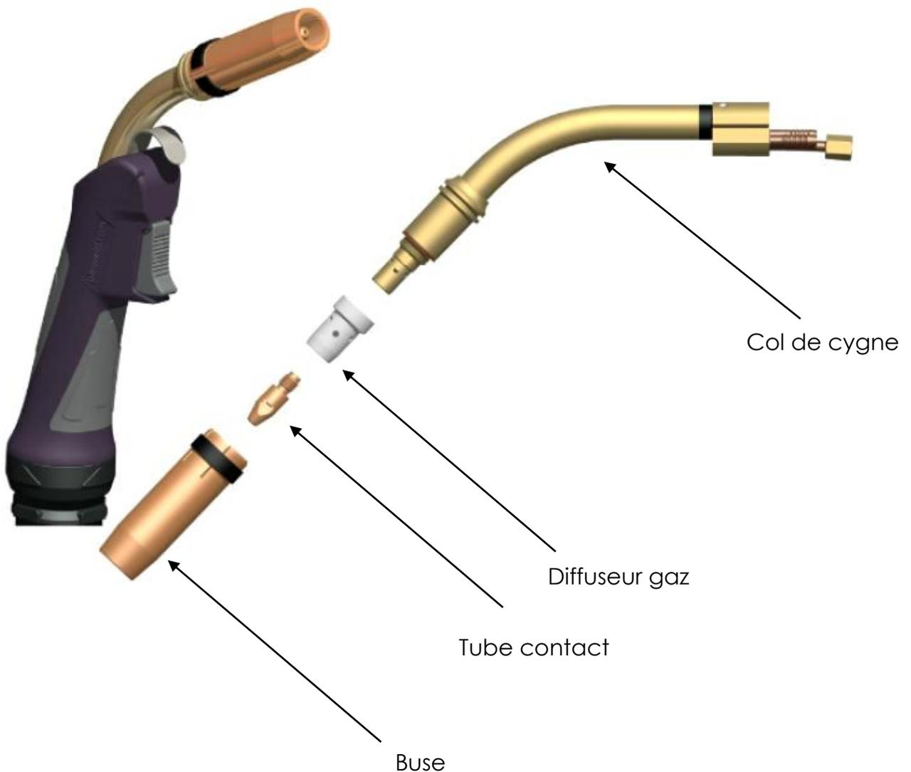
*Exemple de modèle de col de cygne sur B501W*
