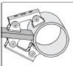
Tient des blocs pour soudage par points.
