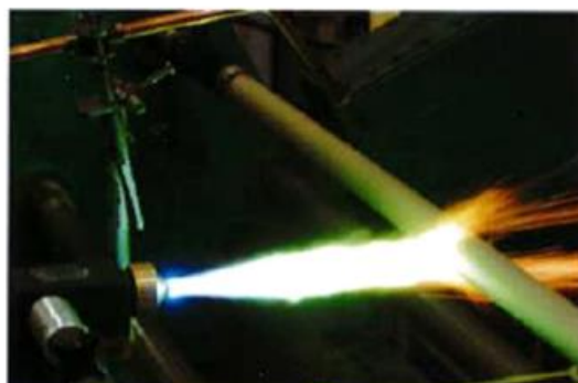
SPRAYWELDER Piston de pompe de trou de fond pulvérisé par un Spraywelder J-3 utilisant les produits Colmonoy Colmonoy 5, 5A, 62 SA
