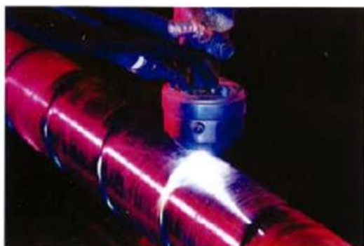
PLASMA À ARC TRANSFÉRÉ Application typique utilisant ce type de processus Colmonoy 83PTA appliqué à un bloc qui deviendra une vis de boudineuse
